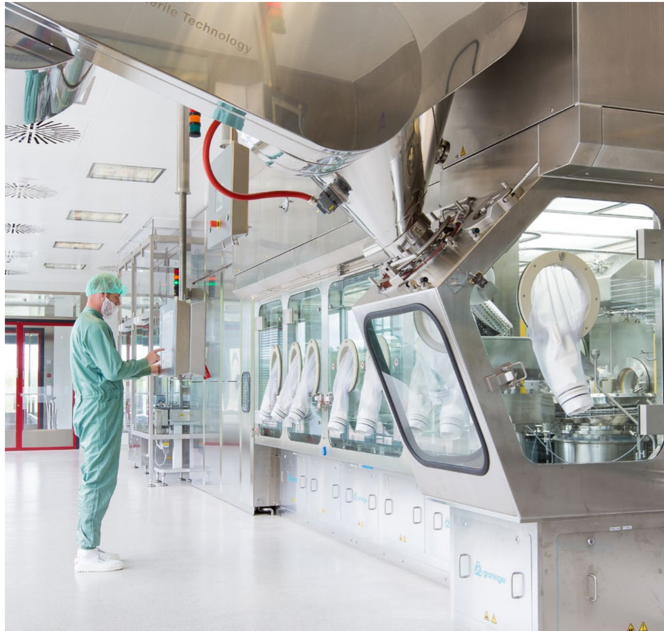
Abb.1 Fertigungslinie für Impfstoffe mit modernster Isolator-technologie- Gefriertrocknungstechnik und Abfülltechnik
